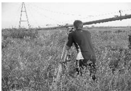
*Рис. 2. Измерение прогибов трубопровода дождевальной машины*
