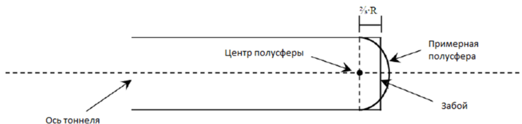
Рис. 3. Приближение забоя выработки с полусферой с радиусом, равным радиусу туннеля. Положение центра полусферы перенесено на \frac{1}{2}R относительно забоя выработки, где R обозначает радиус туннеля
