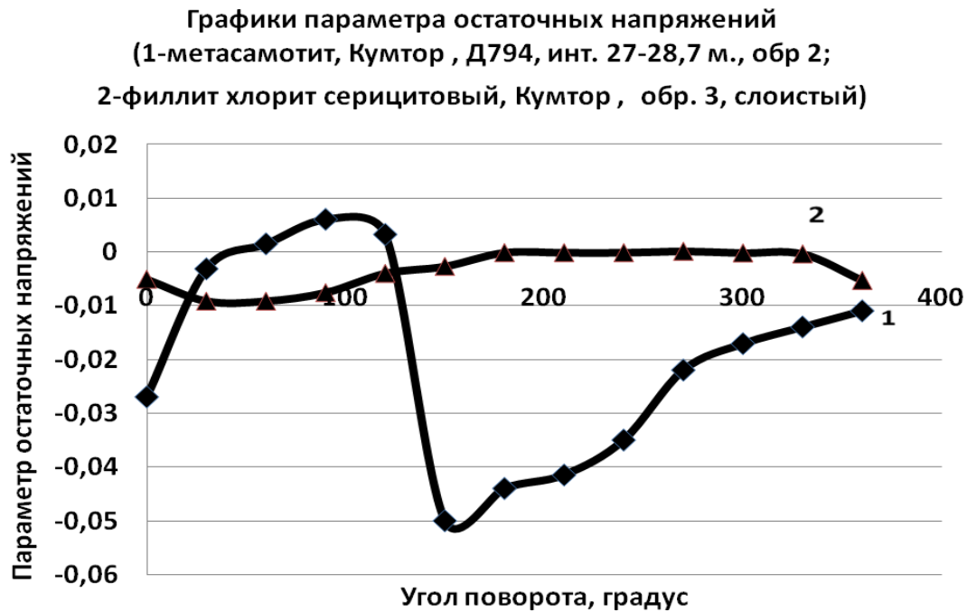
Рис. 1. Графики параметра остаточных напряжений в объеме образца метасамотита - 1 и хлорит серицитового филлита - 2 для разных направлений (рудник Кумтор, \theta^0 совпадает с направлением севера)
