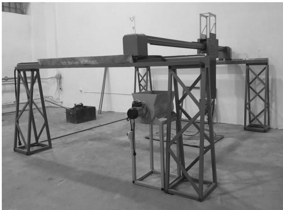
Рис. 3. Строительный 3D принтер в университете ВКГТУ им. Д. Серикбаева
