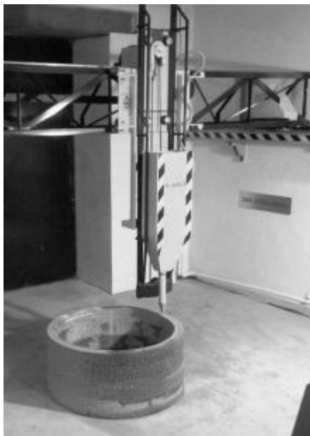
Рис. 1. Пример изготовления стенового кольца круглой формы 3D-принтером
