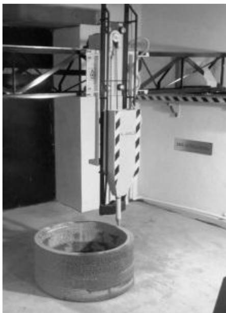
*Рис. 1. Пример изготовления стенового кольца круглой формы 3D-принтером*
