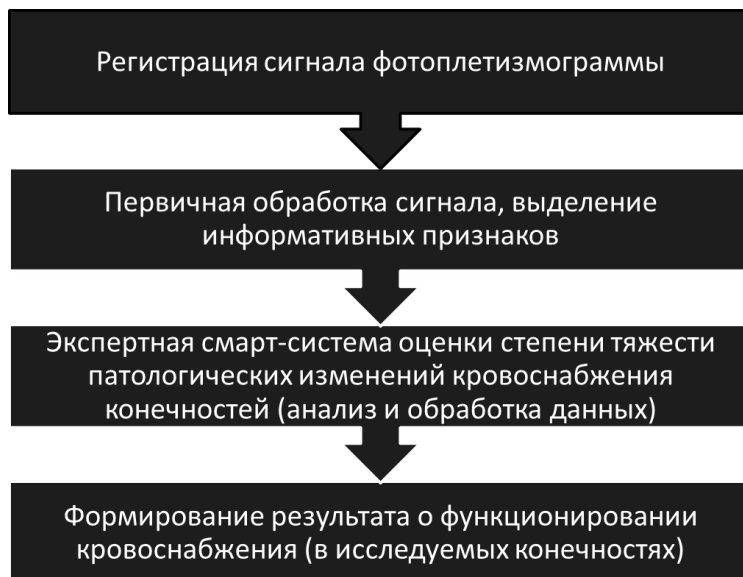
Рис. 1. Обобщенная схема работы предлагаемого решения
